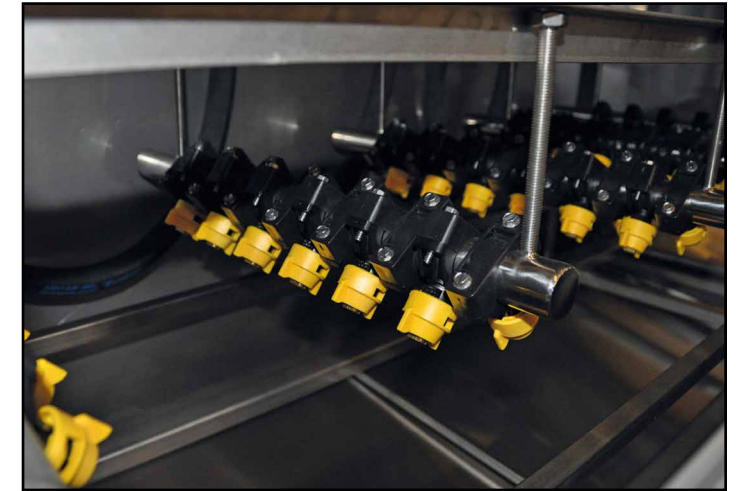
48 dysz niskociśnieniowych rozmieszczonych w 5 rzędach zapewnia dokładne płukanie
